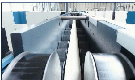
Szíjhajtás felülnézetben. Jobb oldali képek előlnézetben mutatják a szíjhajtás rendszert.
