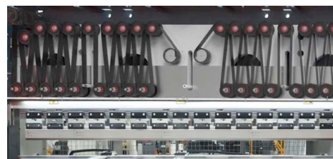
Visszatérítő rugók, biztonsági lézer fénykapu.
