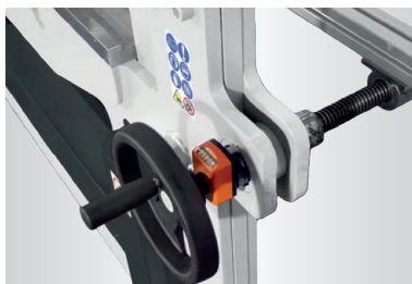
▶ kézikerékkel állítható hátsó ütköző, számlálóval
