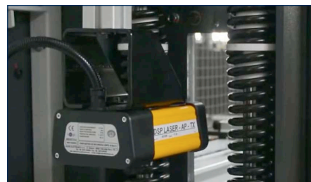
Visszatérítő rugók, biztonsági lézer fénykapu.
