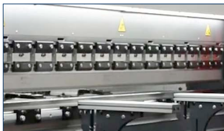
Kézi működtetésű felső gyors befogású szerszámtartó.
